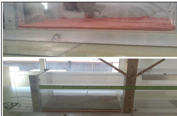
Después de haber colocado siete capas, pusimos en marcha el motor del simulador para conseguir la compresión del bloque de sedimentos según los parámetros indicados en la siguiente tabla:
